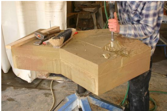
Erste Flächenarbeit nach dem Zuarbeiten der Außenform
